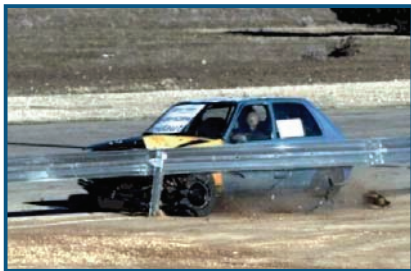
Ensaio TB 11 Carro 900 kg, a 100 km/h e 20°
