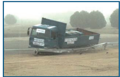
Ensaio TB 42 Caminhão 10.000 kg, a 70 km/h e 15°
