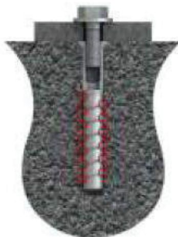
Ancoragem TSM-A22x155 com parafuso M16x40 DIN933 e arruela M16 DIN9021
