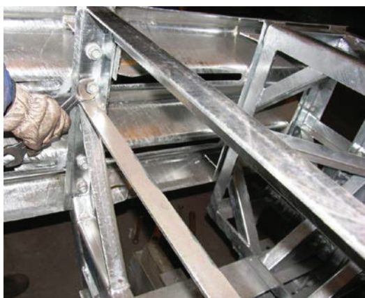
Retirada de uma lâmina lateral de cabeça
